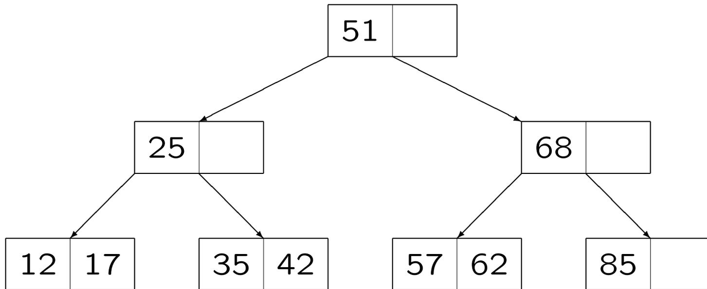
Neredundantní B-strom (2-3)-strom
